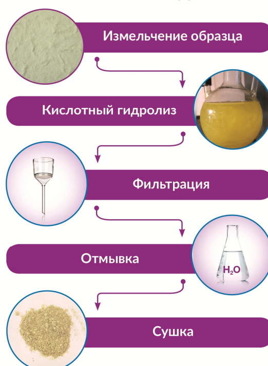
Рис. 1. Схематический процесс выделения порошковых целлюлоз из макулатурной массы (на примере ММ картона). В ряде случаев в изображение не включена стадия промывки образцов водой
