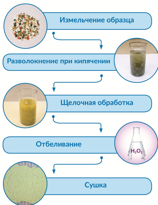
Рис. 1. Схематический процесс выделения порошковых целлюлоз из макулатурной массы (на примере ММ картона). В ряде случаев в изображение не включена стадия промывки образцов водой
